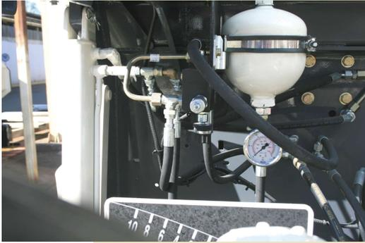
Este sistema alivia el peso de la mesa alisadora para que la misma fluctúe sobre la mezcla bituminosa con el menor ángulo de ataque posible, favoreciendo el perfecto acabado del pavimento, mejor tracción y respuesta rápida cuando se altere el espesor aplicado.
